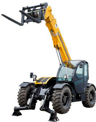
MANIPULADOR TELESCÒPIC MANIPULADOR TELESCÓPICO 17m 4000KG
