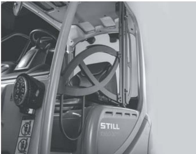
Sistema de retención del conductor IWS
