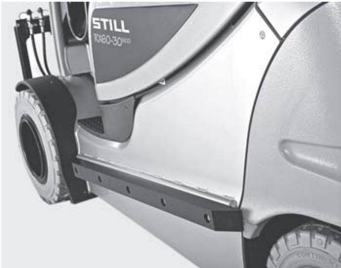
Protección lateral para condiciones especialmente difíciles
