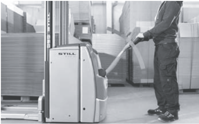
La seguridad de serie: dependiendo del ángulo del timón, la velocidad se adapta automáticamente a la distancia entre el operador y la máquina
