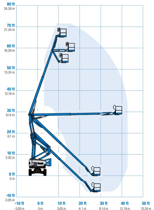
\* En el sistema métrico, altura de trabajo = altura de la plataforma + 2 m.
