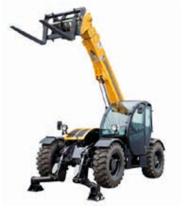
MANIPULADOR TELESCÒPIC MANIPULADOR TELESCÓPICO 17m - 18m 4000KG
