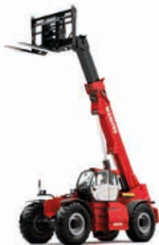
MANIPULADOR TELESCÒPIC MANIPULADOR TELESCÓPICO 6m 2500KG
